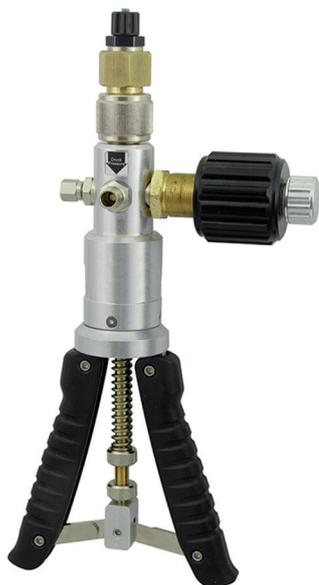
Parallel zum Prüfling muss mit einem entsprechend genauen Druckreferenzmessgerät der Druck bestimmt werden, des Weiteren die Ausgangsspannung der Ausgangsstrom der Elektronik.
