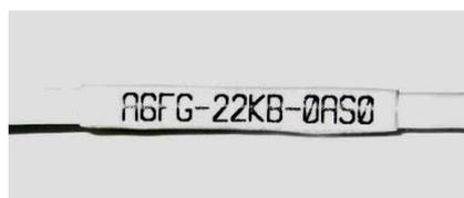
Der Kalibriercode befindet sich auf einem Label am Messkopfkabel (in der Nähe der Elektronikbox). Sollten Sie das Kabel kürzen, heben Sie bitte unbedingt das Label auf bzw. notieren Sie sich den Code, da dieser bei einem Messkopftausch benötigt wird.
