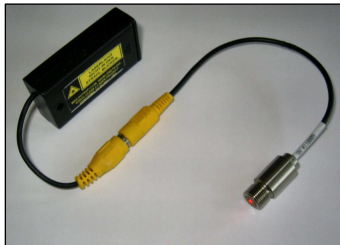
Rechtwinkel-Spiegelvorsatz Ermöglicht Messungen im 90°-Winkel zur Sensor- achse [ACCTRAM].
