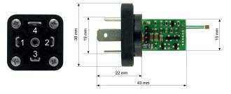
Die Messung der Ausgangssignals sollte mit separater Signalmasse erfolgen, um Messfehler durch Spannungsabfall an der Versorgungsmasse zu vermeiden.
