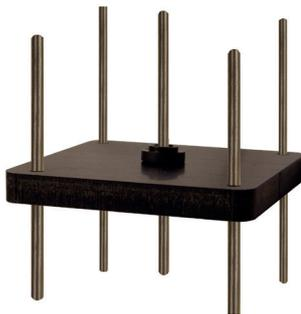
Schließen Sie dann die Elektroden mit den Lüsterklemmen an das Kabel an. Achten Sie auf die richtige Reihenfolge gemäß der Anschlussbelegung. Die Bezugselektrode COM ist am längsten, dann folgt E1 (unterstes Niveau), E2, E3 und zum Schluss die kürzeste Elektrode E4 (oberstes Niveau), damit ist der Fühler fertig aufgebaut und kann am Behälter montiert werden.
