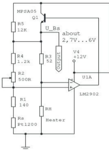
Die beiden Elemente (Heizer RH und Sensor RS) können in einer Brücke verschaltet werden. Die Widerstände R1, R2 und R3 bestimmt die Temperaturdifferenz ( $\Delta T$ ) zwischen RS und RH. Dies ist der Zustand auf den die an der Brücke anliegende Spannung geregelt wird.
