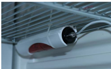
Abbildung 10: Unter dem Regalfach angebrachter Fühler mit Glykol-Ampulle
