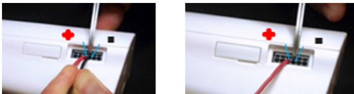
Abbildung 17: Nach unten in die obere rechteckige Öffnung drücken, den Draht einschieben, das Werkzeug entfernen
